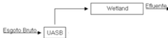
**Figura 6:** Esquema do sistema de tratamento.
